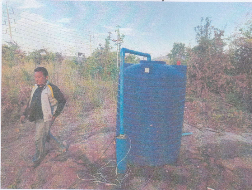
ภาพกำลังสูบน้ำเพื่อทดสอบหาปริมาณน้ำ
